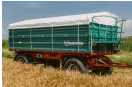
» Ein sicheres Podest zur Kontrolle des Befüllvorgangs sowie eine reißfeste Rollplane für den Transport
