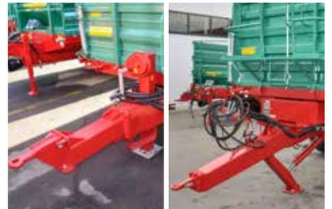
» Stützfuß in verschiedenen Varianten – mechanisch, hydraulisch, Y-Variante oder Sattelstützwinde teleskopierbar mit zwei Geschwindigkeiten
