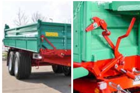
» Hydraulische Pendelwandentriegelung
