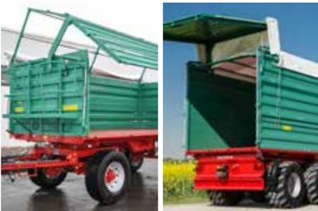
» Hydraulische Öffnung der Seitenwand
