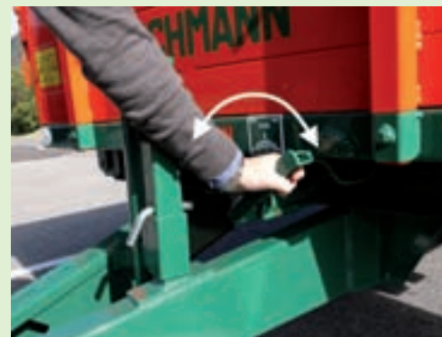
„LOCHMANN-KIPPMATIK“, zentralisierte Kipplagersteuerung
