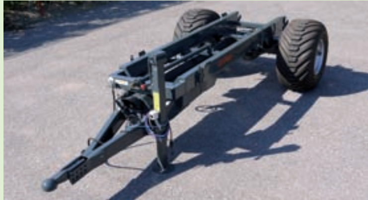
RW 70 Universalrahmen für Transporteraufbauten
