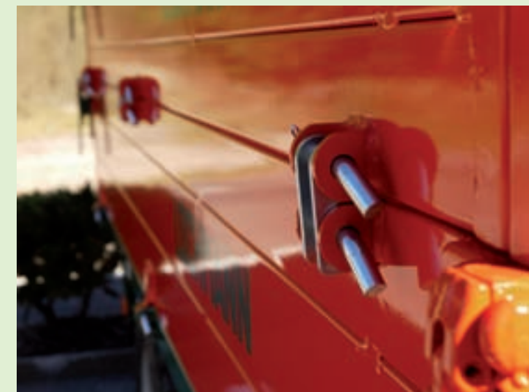
„Lochmann Duo-Lock“ Scharniere für Aufsatzwände mit 3 Funktionen
