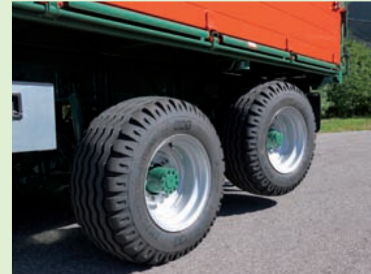
Liftachse (Achse hydraulisch heben)
