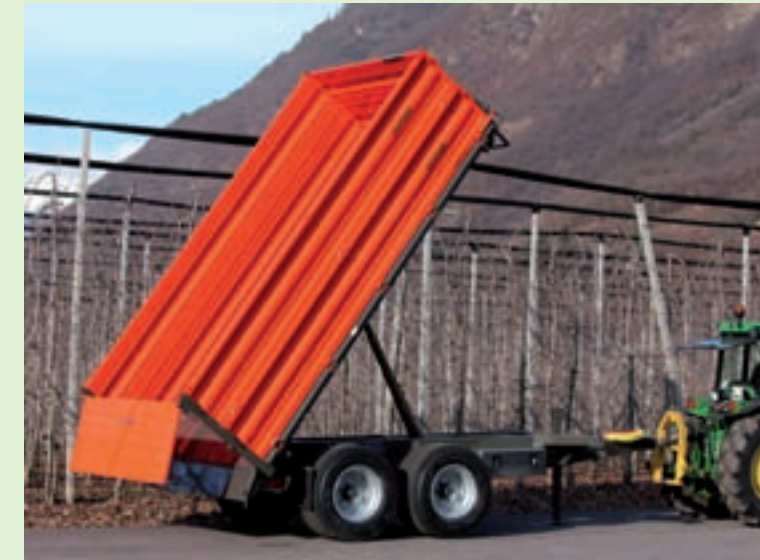
Heckklappe hydraulisch (nur ohne Kippmatik möglich)
