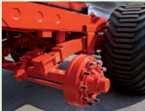
Tandem Modelle: mit Bogie-Aufhängung pendelnd und gefedert
