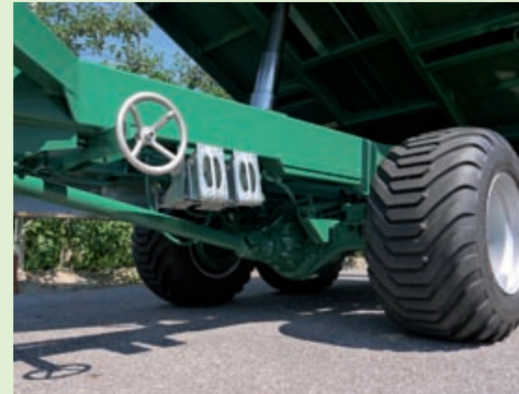
Triebachse mechanisch oder hydraulisch
