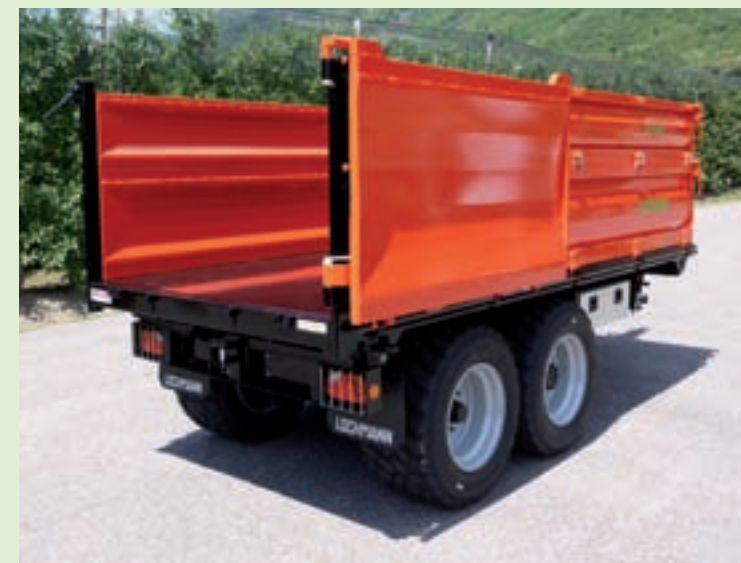
Rückwand seitlich zu öffnen
