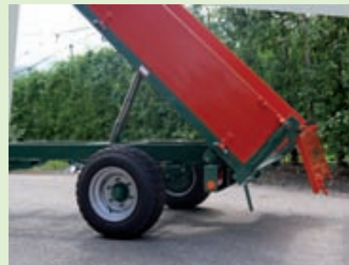
Rückwand mit Zentralverriegelung, oben und unten zu öffnen (ausg. RM15-25)
