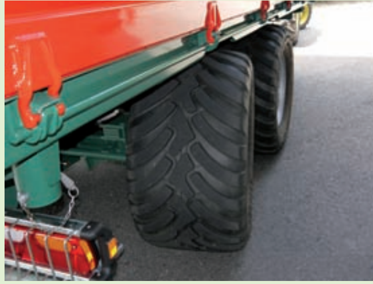
Lenkachse als Nachlaufachse oder mit Zwangslenkung
