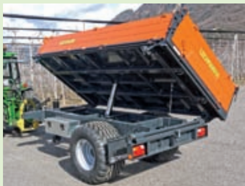
Geschützte Lichtanlage im Stahlträger integriert (bis Breite 2000 mm)
