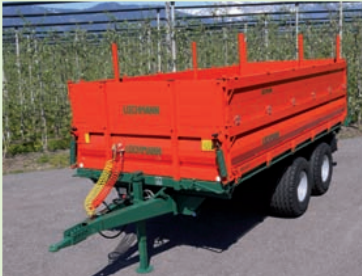
Holzrunen in Brücke einsteckbar
