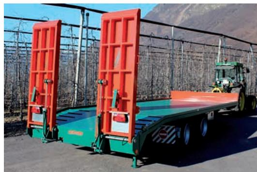
Ladefläche fix, hinten abgeschrägt mit hydr. Rampen
