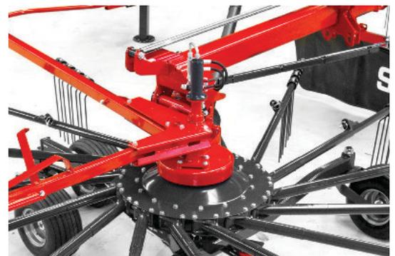
Hydraulische Einstellung der Höhe von rotor.
