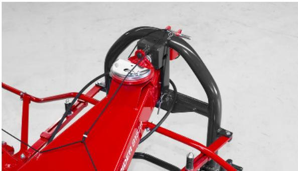
Schwenkbock mit Stabilisatoren ermöglicht ein leichtes Folgen dem Traktor.
