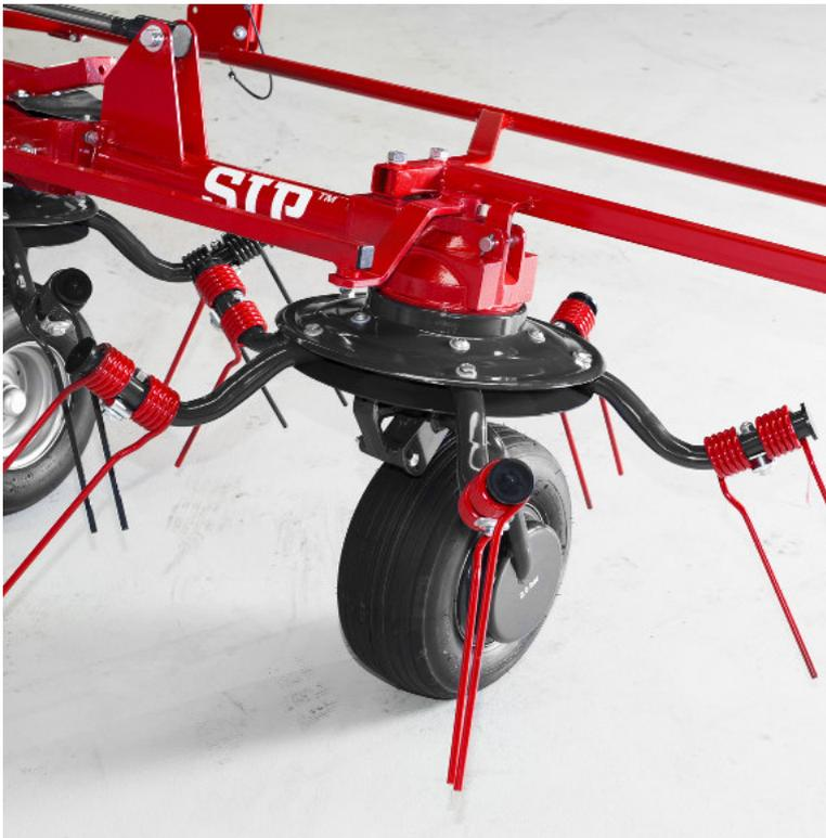
Kreisel und Federzinkenarme sind beim Wenden hoher Kraft ausgesetzt, weshalb sie aus robusten runden Rohren gefertigt werden. Den Federzinkenarmen bietet weitere Verstärkung der untere Ring an dem Kreisel.
