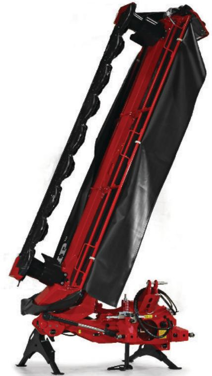
Für den Transport ist die Maschine 120° hinter dem Schlepper schwenkbar und auf einer Fläche von nur 3,2 m<sup>2</sup> abstellbar.
