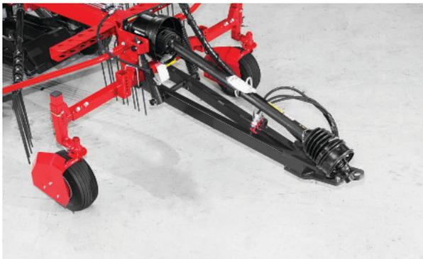
Die Deichsel ist mit dem Hebeglied des Traktors verbunden und erlaubt dem Traktor perfekt zu folgen und gibt der Maschine einen kleineren Wenderadius
