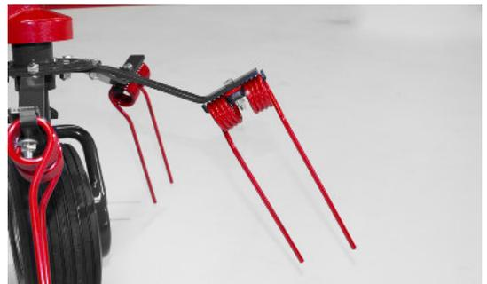
Träger der Federzinken aus flachem HARDOX Stahl für einen zuverlässigen Betrieb auch bei großen Mengen des Futters. Asymmetrische Doppelzinken aus bestem Federstahl für eine saubere Abholung.
