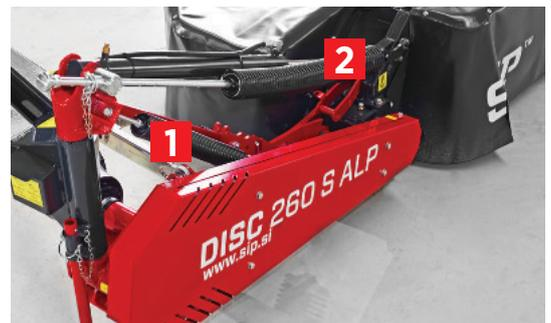
DUAL SPRING (Entlastungssystem): Zwei Entlastungsfedern (1 Feder zur Entlastung des äußeren Balkens, 1 Feder zur Entlastung des inneren Balkens)
