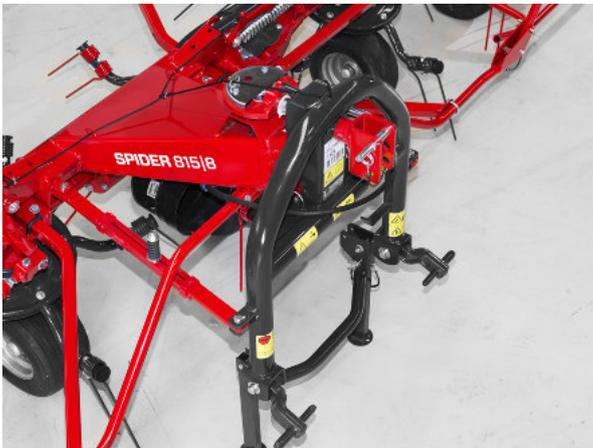
Schwenkbock, unterstützt durch Stabilisatoren ermöglicht es, dem Traktor leichter zu folgen.
