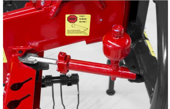
Zusätzliche Stoßdämpfer (optional für STAR 350|8 ALP) ermöglicht eine einfache Folgung der Maschine.
