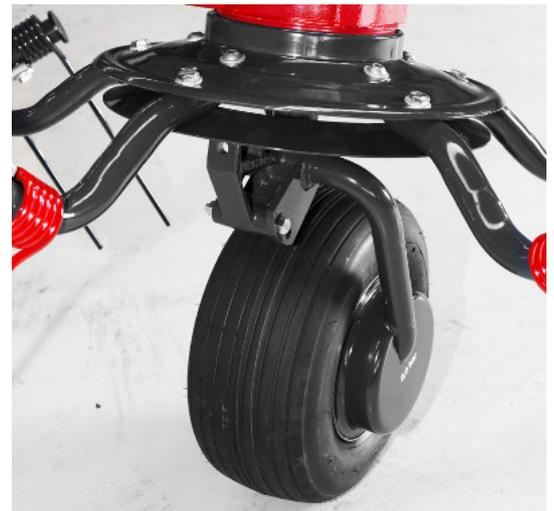
Räder mit MehrgangEinstellung der Höhe und schnelle Streuwinkelverstellung mit verschiebbaren Rädern.
