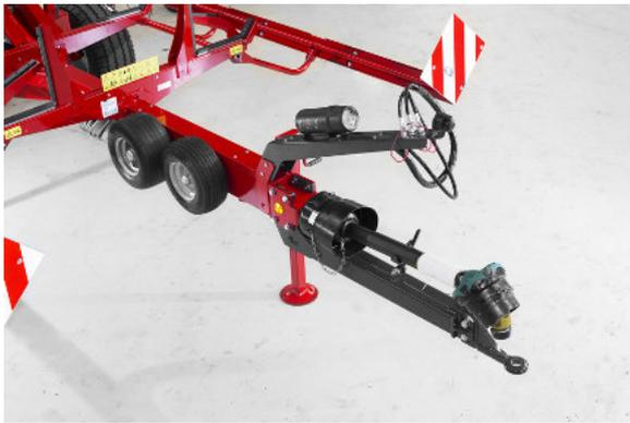
Verstellbare Schwenkblock mit Transportrahmen für Geschwindigkeit bis zu 40 km/h.
