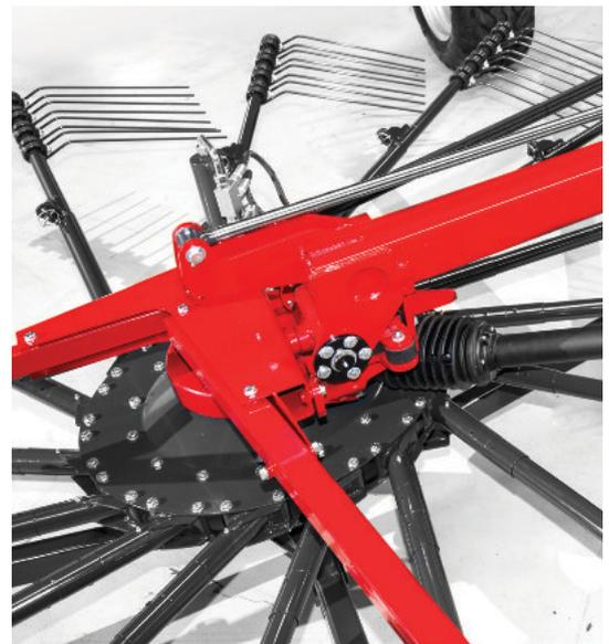
Beide Kreiselbewegen sich unabhängig von der Fahrgestellarm, so, dass eine perfekte 3D-Bodenkontur ermöglicht wird. Federzinken bewegen sich parallel zum Boden, wodurch eine saubere Arbeit bei jeder Geschwindigkeit gesichert ist.
