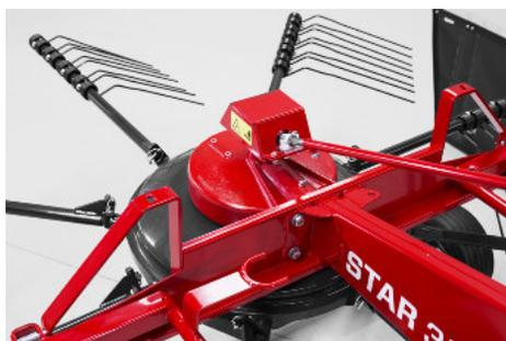
Robustes Getriebegehäuse mit langlebigen Getriebe/ Zahnrad geschmiert mit halbflüssigem Fett, was die Haltbarkeit und Leichtigkeit des Antriebs sicherstellt.
