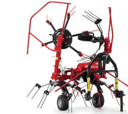
System zur Rotation der externen Kreiseln für eine kleinere Transportbreite.
