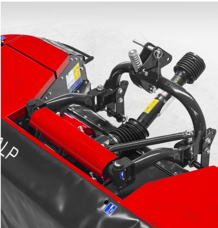
Hydraulische Seitenverschiebung von 200 mm links und rechts (optional) verbessert die Arbeit in extremen Hanglagen (sowie Flachland) und verbessert den Futterfluss durch die Balken.
