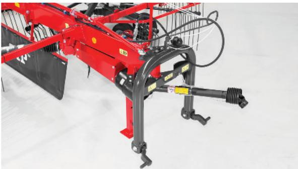
Die Nachlauflenkung über Gestänge zur Hinterachse ermöglicht einen sehr engen Wenderadius von bis zu 55°.
