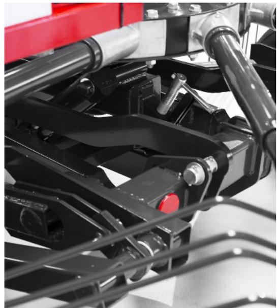
Leichte und einfache Höhenverstellung des Kreisels mit dem Gewindebolzen
