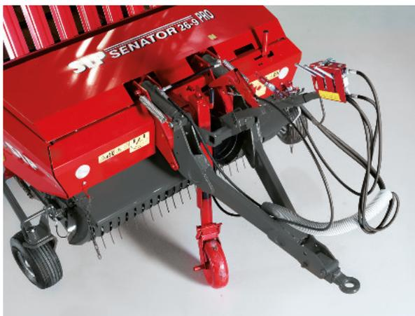
Hydraulisch gesteuerte Deichsel ermöglicht heben oder senken von front Teil von Ladewagens für besseres Straßen fahrt oder fahrt über Unebenheiten.
