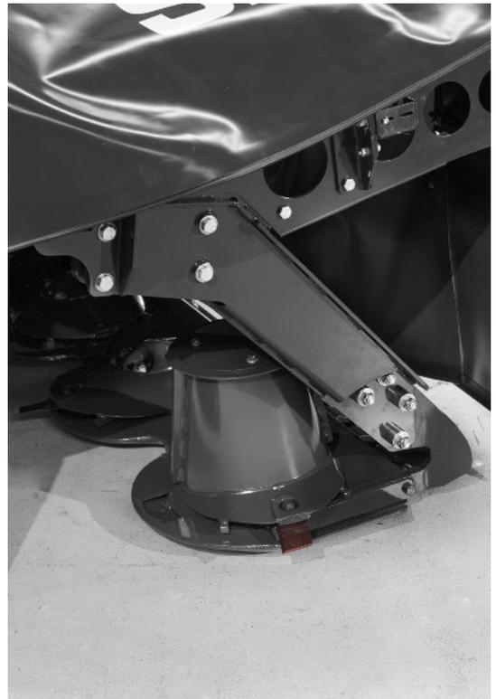
Die Konstruktion des Mähers ist so ausgelegt, dass der Schwerpunkt so nah wie möglich am Traktors liegt. Der Mähbalken ist auf beiden Seiten mit Sohle verstärkt, was die Schadengefahr an den Lagern am Mähbalken reduziert.
