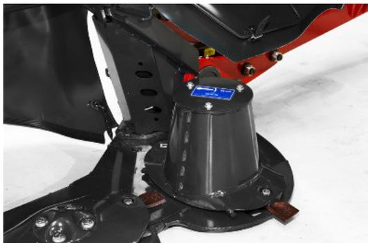
Direktantrieb durch das Getriebe hinter der ersten Scheibe.
