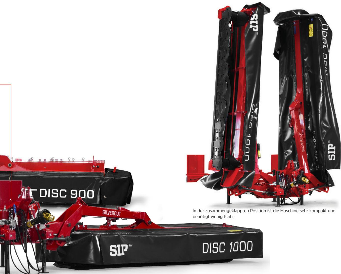
In der zusammengeklappten Position ist die Maschine sehr kompakt und benötigt wenig Platz.
