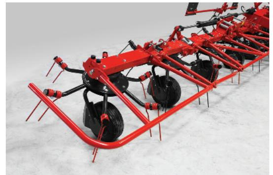
Verbundene Schutzvorrichtungen für zusätzliche Stabilität und Steifigkeit.
