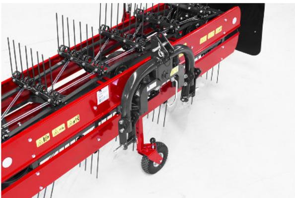
Dreipunkt-Anbaubock  $\pm 6$  Grad sorgt für effiziente Bodenkontur und eine längere Lebensdauer der Gelenkwelle.
