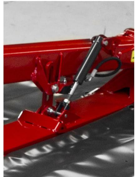
Hydraulisch gestützte Stabilisierung der Mähbalken ermöglicht sequentielle Aufhebung der Mähbalken. Zuerst hebt sich die Innenseite der Mähbalken und danach die Außenseite.
