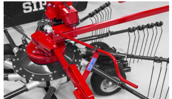
Leichte und einfache Höhenverstellung der Kreiseinheiten.
