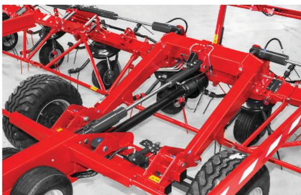
Durchdachtes hydraulisches Klappsysteem ermöglicht eine schnelle Arbeitsvorbereitung, das Wenden und Transport selbst wie auch einfaches Rückwärtsfahren während der Arbeit.
