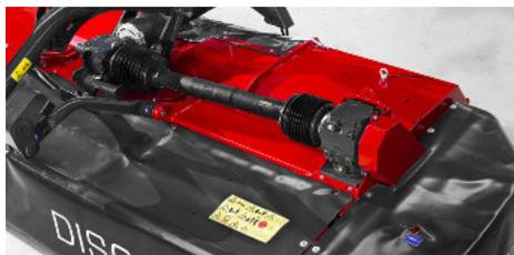
Direktantrieb auf die erste Mähscheibe über Gelenkwelle, Winkelgetriebe und Doppelkreuzgelenk
