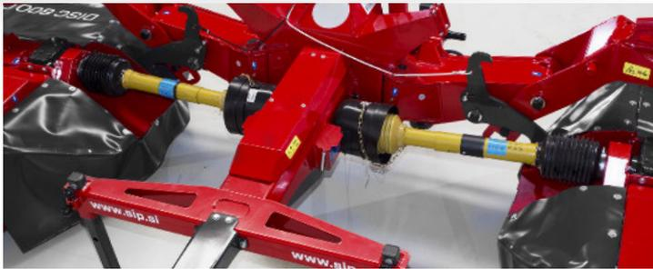
Direktantrieb auf die erste Mähscheibe über Gelenkwelle, Winkelgetriebe und Doppelkreuzgelenk
