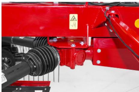
Der Y-Antrieb reduziert die Belastung an der Gelenkwelle gewährleisten eine längere Lebensdauer der Maschine.
