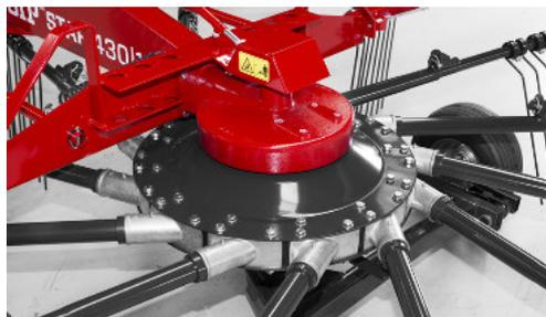
Einzel abnehmbare Zinkenarme, minimale Wartungskosten, hochwertige Materialien, große Kurvenbahn und eine lange Lebensdauer sind die wichtigsten Vorteile der modularen Kreiselausführung.
