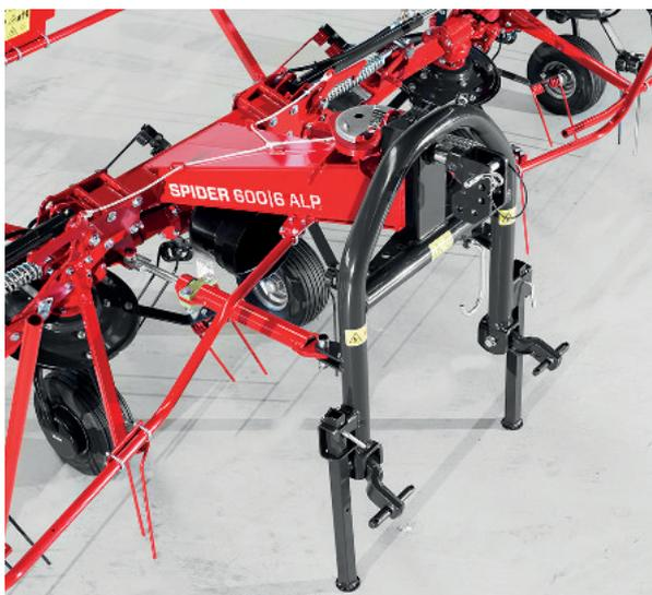
Schwenkbock durch Dämpfungstreben unterstützt kann dem Traktor leichter folgen (SPIDER 400|4 ALP, 600|6 ALP)
