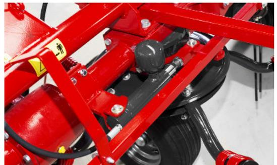
Alle mit HS gekennzeichneten Modelle sind serienmäßig mit einem zentralen hydraulischen Verschiebung ausgestattet.
