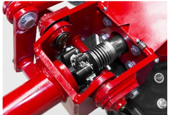
Ein Doppelkreuzgelenk und Klauenkupplung in einem stabilen Gehäuse gewährleisten zuverlässigen und ruhigen Lauf sowie eine ausgezeichnete Lagerung.
