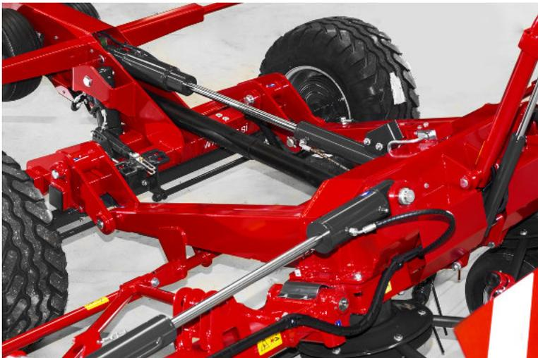
Kreiselneigungseinstellung (SIP-Patent) von 15° bis 21° (optional - hydraulisch) für gleichmäßiges Streubild.
