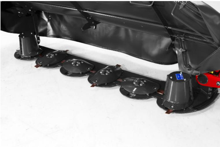
Kufen aus verschleißfestem Stahl (HARDOX) gewährleistet eine lange Lebensdauer sowohl bei Mähbalken als auch bei Scheiben. Die geschwungene Form der Kufen bietet eine große Auflagefläche und eine hervorragende Gleitfähigkeit durch die Oberfläche.
