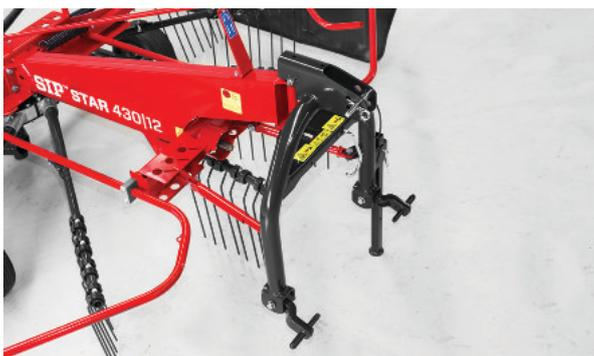
Schwenkbock durch Dämpfungstrebe unterstützt kann dem Traktor leichter folgen.
