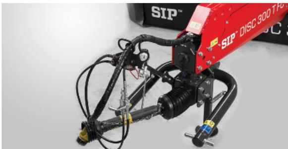
Das Eingangsgetriebe auf dem Gestänge kann um 90° gedreht werden
