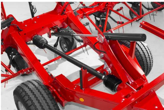
Durchdachtes hydraulisches Klappsystem ermöglicht eine schnelle Arbeitsvorbereitung, das Wenden und Transport selbst wie auch einfaches Rückwärtsfahren während der Arbeit.
