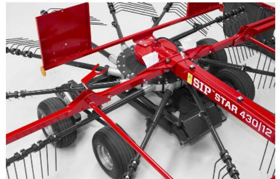
Mit dem Hydrauliksystem kann der Kreiselschwader um 500 mm für die Transportlage angehoben werden.
