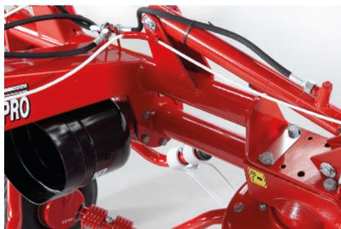
Direktantrieb ist über Gelenkwelle mit der Sicherheitskupplung bis zum Winkeltrieb und nach vorne über robuste Getriebe und Doppelkreuzgelenk mit Welle an den Kreisel verteilt.
