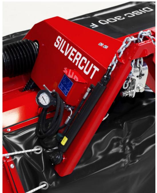
Eine robuste Anschluss mit einer hydropneumatischen Entlastung bietet ausgezeichnete Reaktion auf bewegtem Gelände. er Mähbalken auf die Bodenfläche.
