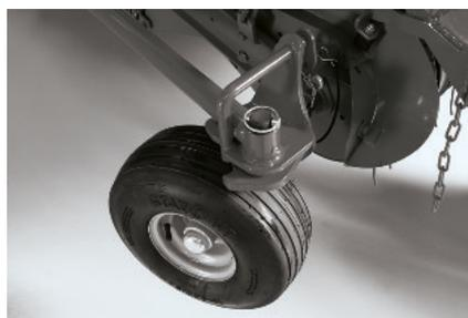
Schwenkräder am Gerät ermöglicht eine bessere Futter abholen.
