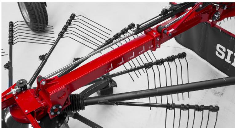
Stufenlos hydraulische Einstellung der Schwadbreite selbst während der Arbeit. (STAR 850|26 T)
