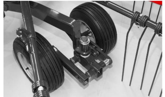
Flexible Schritt - Tandemachse auf dem Kreisler für eine ausgezeichnete Boden Anpassung und höhere Geschwindigkeit. Ein breites Fahrgestell mit 4 oder 6 Rädern, positioniert nahe an den Federzinken ermöglicht einen gleichmäßigen und sauberen Schwad über die gesamte Arbeitsbreite.
