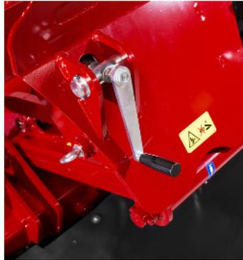
Die Gummiwalzen (RC) gewährleisten gleichmäßiges Kneten des Futters. Die Intensität des Knetens ist stufenlos einstellbar.
