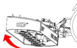
Im Falle eines Aufpralls auf ein Hindernis wird die Sicherung sofort freigesetzt. Durch die besondere Lage des Scharniers bewegt sich der Mähbalken gleichzeitig nach hinten und nach oben. Nach mit dem Aufprall auf ein Hindernis kehrt der Mähbalken automatisch in die Betriebsstellung zurück.
