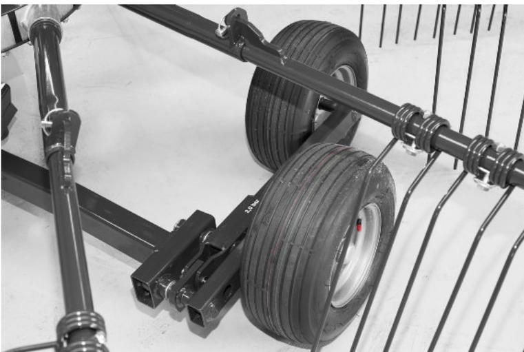
Das Schritt - Tandemfahrwerk (SIP-Patent) ist in jede Maschine serienweise eingebaut, gewährleistet eine optimale Bodenpassung und reduziert die Belastung an der Maschine.
