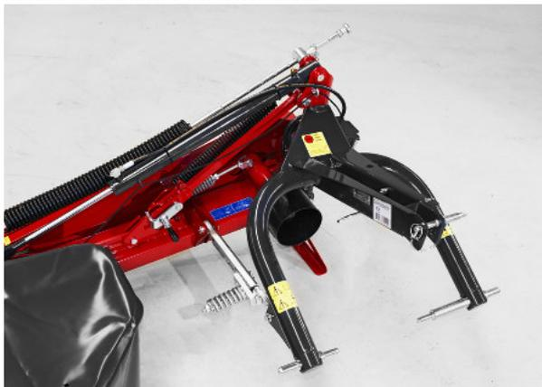
Federspann des Riementriebes
