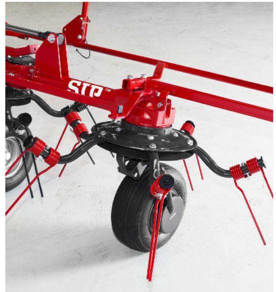
Kreisel und Federzinkenarme sind beim Wenden hoher Kraft ausgesetzt, weshalb sie aus robusten runden Röhren gefertigt werden. Den Federzinkenarmen bietet weitere Verstärkung der untere Ring an dem Kreisel.
