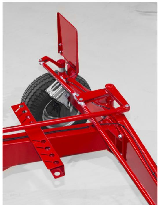
Robuste Lenkmechanismus macht es möglich, gute Abfolge des Traktors während des Wendens zu sichern, trotz der großen Länge der Maschine.
