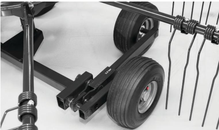
Ein patentiertes Schritt - Tandemfahrwerk (Serie) sorgt für optimale Boden Anpassung für höhere Arbeitsgeschwindigkeiten bei niedriger Belastung der Maschine.
