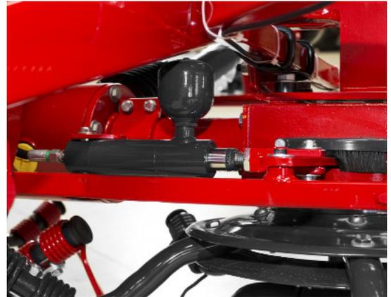
Hydraulikzylinder steuert alle Räder auf der rechten und linken Seite. Die Bedienung benötigen nur einen EW Steuerung. Der Gegendruck für die Bedienung führt durch den Hydrospeicher integriert in den Zylinder.
