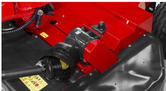
Spezialgetriebe am Mähbalken gewährleistet Belastungsreduktion an der Gelenkwelle.
