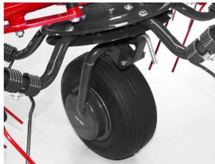
Räder mit MehrgangEinstellung der Höhe und schnelle Streuwinkelverstellung mit verschiebbaren Rädern.
