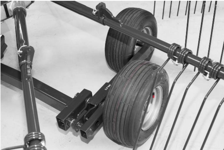
Schritt - Tandemachse für beste Bodenangepassung.
