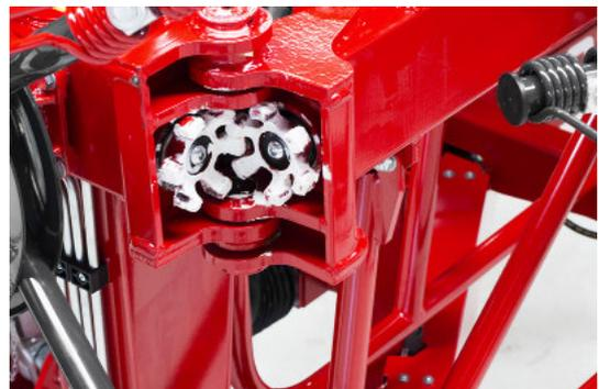
Klauenkupplung ist wartungsfrei und sorgt für eine zuverlässige Kraftübertragung in allen Arbeitsbedingungen.
