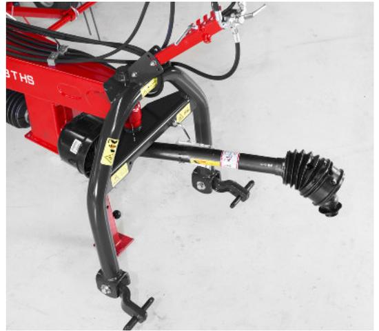
Anbaubock mit Weitwinkel-Gelenkwelle ermöglicht die Maschine den Traktor perfekt zu folgen und gibt der Maschine einen kleineren Wendekreis.
