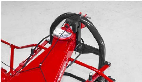
Schwenkbock, verstärkt durch Stabilisatoren ermöglicht es, dem Traktor leicht zu folgen.
