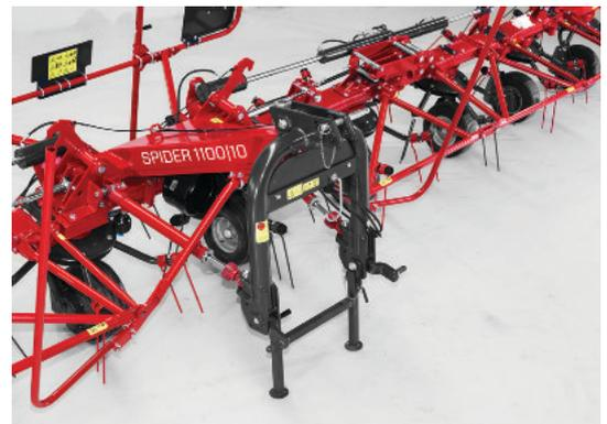
Schwenkbock, unterstützt durch Stabilisatoren ermöglicht es, dem Traktor leichter zu folgen.
