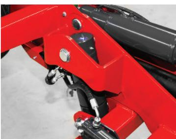
Hydraulische Kreiselneigungseinstellung (SIP-Patent).
