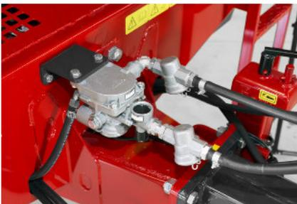
Maximale Brems- Sicherheit bei voll beladenem Stallungstreuer bietet Zweikreis- Druckluft Bremssystem mit ALB Regler.
