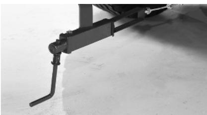
Feststellbremse- Betätigung durch Bremshebel.
