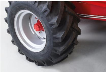
Für die Stabilität und sichere Arbeit im Hang: Tieflader mit breite Spur und 17" Traktorprofil-Bereifung.
