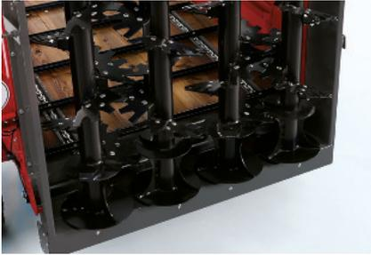
Abnehmbares Streuwerk mit 4 vertikalen Streuwalzen und auswechselbaren Streusegmenten.
