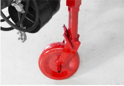
Das große Stützrad für eine stabile Unterstützung wenn der Streuer abgekuppelt vom Schlepper ist.
