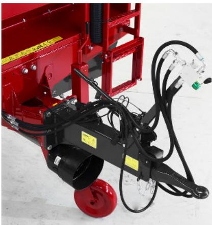
Die Auflaufbremse mit Rückfahrautomatik macht die Fahrt mit geladenen Stalldungstreuer sicherer.
