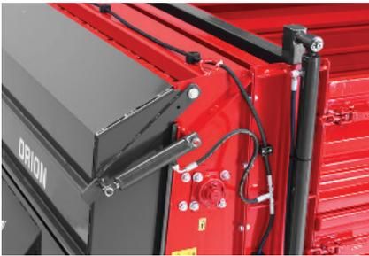
Das Streuwerk kann schnell abgebaut werden. In dem Fall kann der Streuer als Mehrzweck Transportanhänger eingesetzt werden.
