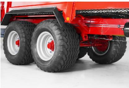
Tandemfahrwerk mit Parabelfederung für Geschwindigkeiten bis zum 40 km/h.
