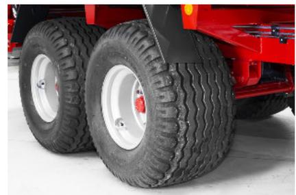
Tandem Fahrwerk für optimale Boden Anpassung und Bodendruckverteilung. Breite Reifen sorgen für zusätzliche Stabilität und größere Auflagefläche.
