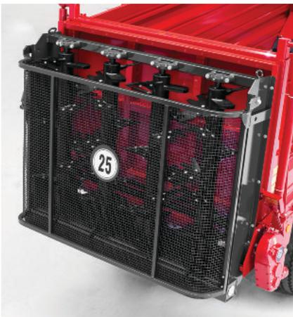
Die robusten Streuwalzen aus außerordentlich Verschleißfester Material, für eine hohe Verteilgenauigkeit und lange Lebensdauer. Streuwerk ist mit Neigung 10° eingebaut. Mit Neigung eingebautes Streuwerk ermöglicht bessere Streubild.
