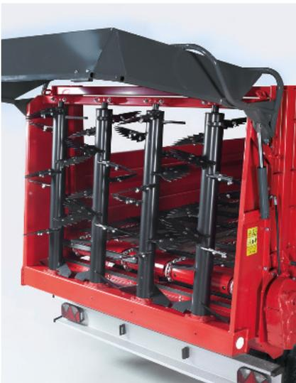
Streuwerk mit 4 vertikalen Streuwalzen und maximaler Streubreite bis zu 8 m.
