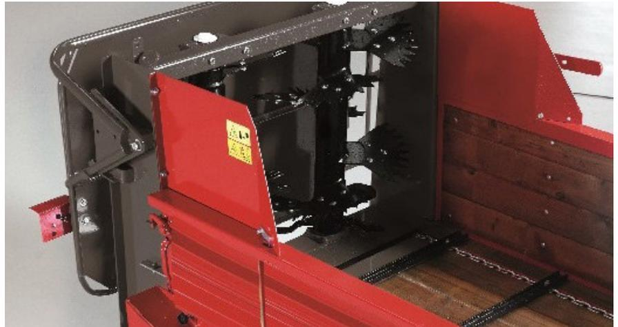
Ein Streuwerksschutz ist optional erhältlich. Die 2 vertikalen Streuwalzen sind mit wechselbaren Fräsklingen bestückt.
