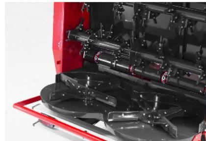
Breitstreuwerk mit 2 vertikalen Walzen und 2 Breitstretellern für Streubreite bis 24 m. Das streuwerk kann abgebaut werden und der Streuer als Anhänger genutzt werden.
