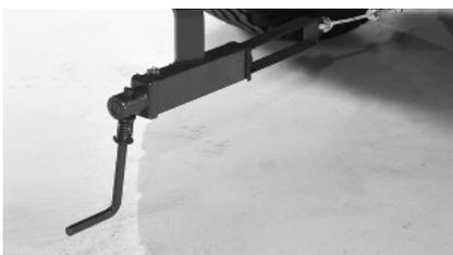
Feststellbremse- Betätigung durch Bremshebel
