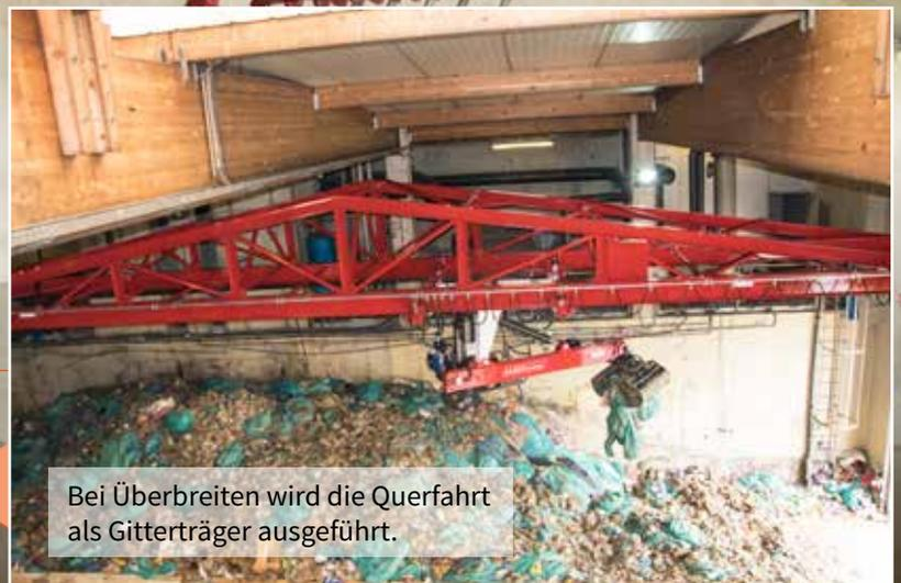
Bei Überbreiten wird die Querfahrt als Gitterträger ausgeführt.
