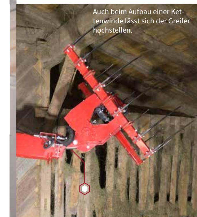
Auch beim Aufbau einer Kettenwinde lässt sich der Greifer hochstellen.
