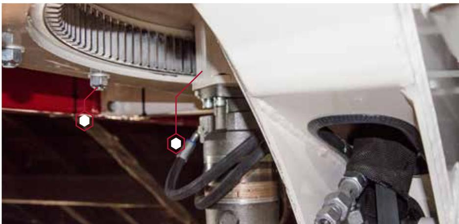
Doppelt verschraubter oberliegender Drehkranz für hohe Passgenauigkeit.
