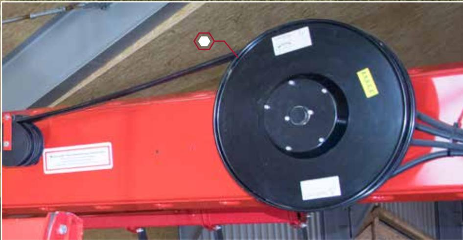
Durch die große Schlauchtrommel wird die Lebensdauer der doppelwandigen Hydraulikschläuche erhöht.
