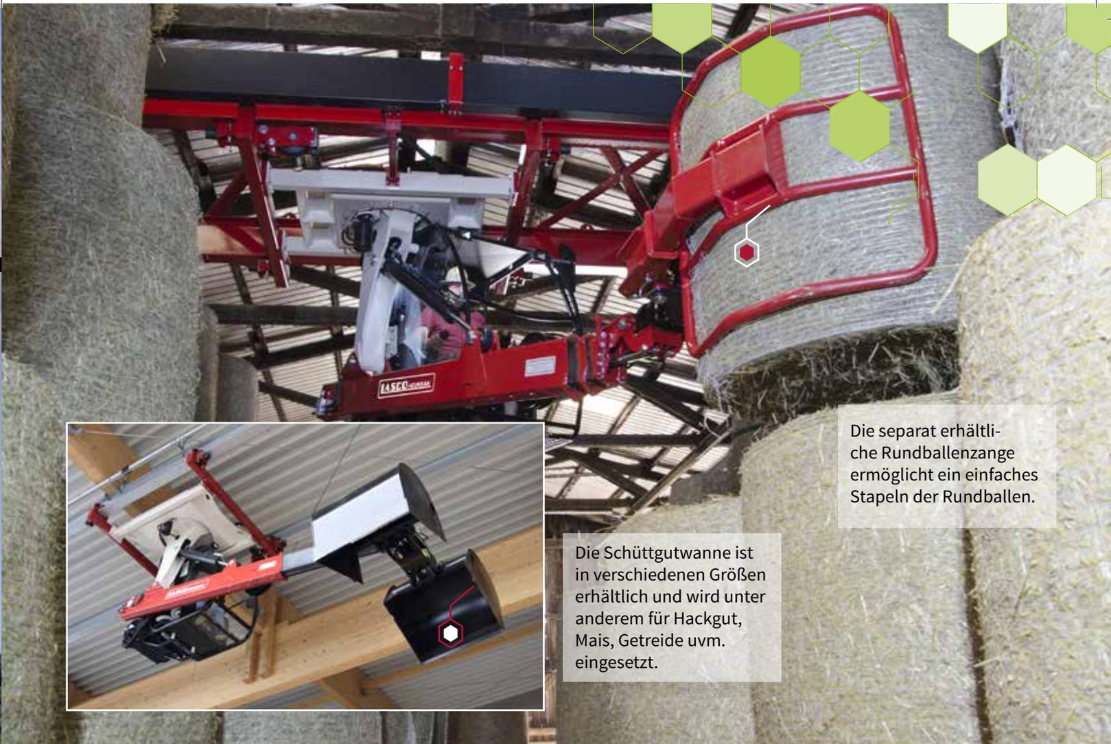
Die separat erhältliche Rundballenzange ermöglicht ein einfaches Stapeln der Rundballen.
