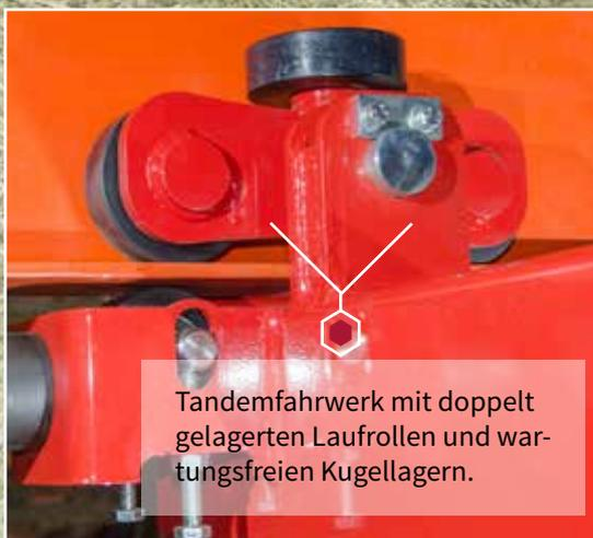
Tandemfahrwerk mit doppelt gelagerten Laufrollen und wartungsfreien Kugellagern.
