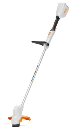
Leichte Akku-Motorsense mit starker Mähleistung. Schneidkreis-Durchmesser 280 mm, einstellbare Schaftlänge per Knopfdruck und werkzeuglose Griffverstellung. Softgriff mit Schalthebel. Durch Tippen des Mähkopfs auf den Boden stellt sich der Mähfaden automatisch nach, Gewicht 2,5 kg<sup>①</sup>.
