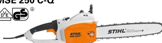
**230 V, 2,5 kW, 4,6 kg** <sup>Ⓛ</sup>. Leistungsstärkste STIHL Elektro-Motorsäge für anspruchsvolle Aufgaben beim Bauen mit Holz. Mit <sup>3</sup>/<sub>8</sub>"-RS3-Sägekette für eine hohe Schnittleistung, seitliche Kettenspannung, vollelektronische Steuerung der Motorfunktionen, Softgriff für angenehmes Arbeiten, Kettenbremse QuickStop Super, LED-Überlastanzeige.
