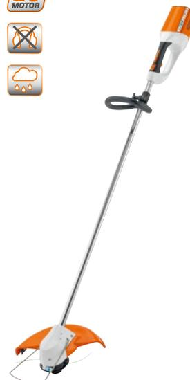
Akku-Motorsense für Mäharbeiten entlang von Hindernissen sowie an Bäumen und Sträuchern. Schneidkreis-Durchmesser 350 mm, stufenlos einstellbarer Bügelgriff, werkzeuglose Griffverstellung, durch Tippen des Mähkopfs auf den Boden stellt sich der Mähfaden automatisch nach, stufenlose Drehzahlregulierung, Abstandsbügel, Gewicht 2,8 kg<sup>①</sup>.
