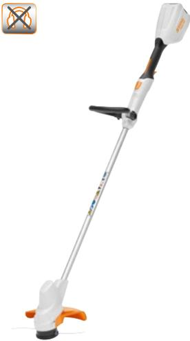
Leichte Akku-Motorsense mit starker Mähleistung. Schneidkreis-Durchmesser 280 mm, einstellbare Schaftlänge per Knopfdruck und werkzeuglose Griffverstellung, Softgriff mit Schalterhebel. Durch Tippen des Mähkopfs auf den Boden stellt sich der Mähfaden automatisch nach, Gewicht 2,5 kg<sup>②</sup>. Mehr zu Ausstattung und technischen Details finden Sie auf Seite 108.
