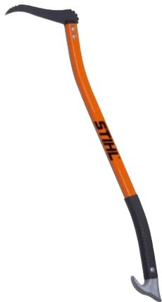
70 cm, 580 g. Für das rücken-schonende Bewegen und Aufnehmen kleinerer Baumstämmen und Holzstücke. Hochfeste Aluminiumlegierung mit Kunststoffgriff. Sicherer Halt durch zusätzlichen Haken am Griffende.
