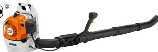
**27,2 cm<sup>3</sup>, 5,7 kg<sup>①</sup>**. Kompaktes und sehr leichtes Gerät. STIHL Antivibrationssystem, 2-MIX-Motor, einfache Startlogik, feststellbarer Gashebel mit Stopptaster, Tragegriff.
