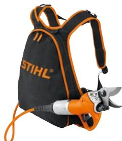
Schnelle und schnittstarke Akku-Schere zum Schneiden von Weinreben und vergleichbaren Hölzern. Für Rechts- und Linkshänder einsetzbar, robustes Aluminiumgehäuse, ergonomische Griffform, elektronisch einstellbare Klingenöffnung, einfacher Klingenwechsel, Gewicht 750 g<sup>①</sup>.
