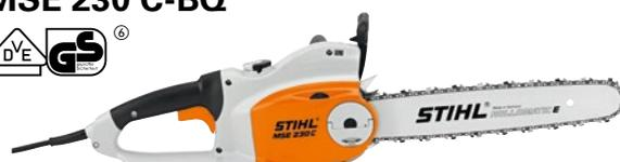
**230 V, 2,3 kW, 4,1 kg** <sup>Ⓛ</sup>. Leistungsstarke Elektro-Motorsäge zum Bauen mit Holz. STIHL Kettenschnellschaltung für schnelles und einfaches Nachspannen der Kette ohne Werkzeug, Kettenbremse QuickStop Super, somit kommt beim Loslassen des hinteren Handgriffs die Sägekette in Sekundenschnelle zum Stillstand, Softgriff für angenehmes Arbeiten, LED-Überlastanzeige.
