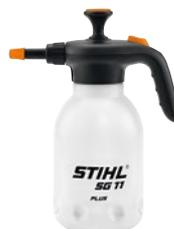
Handspritzgerät mit verstellbarer Düse zur Ausbringung von Reinigungs- und Lösemitteln, z. B. CB 50, Superclean oder Varioclean. 1,5 l Füllvolumen, 3 bar maximaler Druck, EPDM-Dichtungen für Reinigungs- und Lösemittel im pH-Bereich von 7–14. Für eine lange Lebensdauer ist die Pumpe mit einem speziellen Schutzelement versehen.
