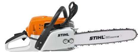
**55,5 cm<sup>3</sup>, 2,8 kW/3,8 PS, 5,6 kg<sup>Q</sup>.** Sehr gut für die Brennholzernte. Sparsamer 2-MIX-Motor, Langzeit-Luftfiltersystem bewirkt lange Filterstandzeiten, werkzeuglose Tankverschlüsse zum sicheren und einfachen Betanken sowie <sup>3</sup>/<sub>8</sub>"-RM3-Sägekette für eine gute Schnittleistung.
