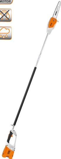
Besonders leichter und kraftvoller Akku-Hoch-Entaster für die Grundstückspflege, den Obstbau sowie die professionelle Baumpflege. Wendig und handlich, mit 1/4"-PM3-Sägekette für exaktes Ansatzverhalten und hohe Schnittleistung, vibrationsarm und leise für den Einsatz in städtischen Bereichen. Mit seitlicher Kettenspannung und verliersicherer Mutter am Kettenraddeckel, Gesamtlänge 240 cm, Gewicht 3,8 kg<sup>Ⓞ</sup>. Mehr zu Ausstattung und technischen Details finden Sie auf Seite 60.
