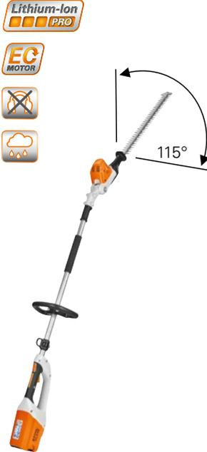
Akku-Heckenschneider für hohe und breite Hecken. Konstanter Messerhub unter Last, zusammenklappbar, ideal einstellbar für Kopf-, Seiten- und Bodenschnitt, um 115° schwenkbarer Messerbalken, lange Reichweite, doppelseitig geschliffene Messer. Transportlänge 125 cm, Gesamtlänge 205 cm, Gewicht 3,5 kg<sup>Ⓞ</sup>. Mehr zu Ausstattung und technischen Details finden Sie auf Seite 135.
