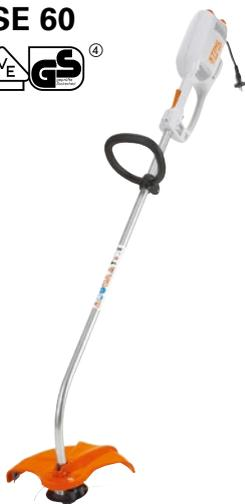
**230 V, 540 W, 3,9 kg<sup>Ⓛ</sup>.** Für Trimm-, Ausputz- und kleinere Flächenarbeiten. Bügelgriff, durch Tippen des Mähkopfs auf den Boden stellt sich der Mähfaden automatisch nach.
