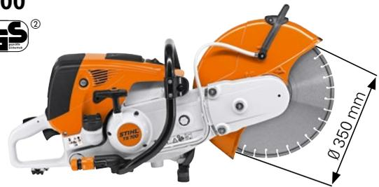
**98,5 cm<sup>3</sup>, 5,0 kW/6,8 PS, 11,7 kg<sup>Ⓞ</sup>**. Stärkster Trennschleifer für 350-mm-Trennschleifscheiben. Der Trennschleifer ist perfekt geeignet für den Einsatz in voller Schnitttiefe und auch auf dem Führungswagen FW 20. Ausgestattet mit Dekompressionsventil und STIHL ElastoStart für ein kräfteschonendes Starten und dem Langzeit-Luftfiltersystem für eine lange Filterstandzeit. Sparsamer 2-MIX-Motor.
