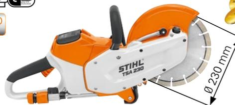
Handlicher Akku-Trennschleifer für 230-mm-Trennschleifscheiben. Innen und außen einsetzbar, Schnitttiefe bis 70 mm, Wasseranschluss mit Kugelhahn und Schlauchkupplung zum Nass-Trennen, Spindelarreterung, wartungsfreier Riemenantrieb, Gewicht 3,9 kg<sup>①</sup>.
