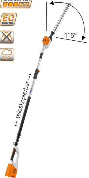
Akku-Heckenschneider für den professionellen Einsatz mit hoher Reichweite durch Teleskopschaft. Stufenlose Drehzahlregulierung, ideal einstellbar für Kopf-, Seiten- und Bodenschnitt, um 115° schwenkbarer Messerbalken, doppelseitig geschliffene Messer. Werkzeuglose Schaftlängeneinstellung durch Schnellspannhebel, Transportlänge 180 cm, Gesamtlänge 260–330 cm, Gewicht 4,4 kg<sup>Ⓞ</sup>. Mehr zu Ausstattung und technischen Details finden Sie auf Seite 135.
