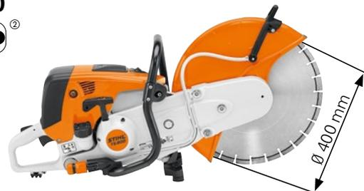
**98,5 cm<sup>3</sup>, 5,0 kW/6,8 PS, 12,7 kg<sup>Ⓞ</sup>**. STIHL Trennschleifer für 400-mm-Trennschleifscheiben. Erreicht die maximale Schnitttiefe von 145 mm, reduziertes Gewicht durch Magnesiumschutz. Auch perfekt geeignet für Trennschnitte auf dem Führungswagen FW 20. Ausgestattet mit Dekompressionsventil und STIHL ElastoStart für ein kräfteschonendes Starten und dem Langzeit-Luftfiltersystem für eine lange Filterstandzeit. Sparsamer 2-MIX-Motor.
