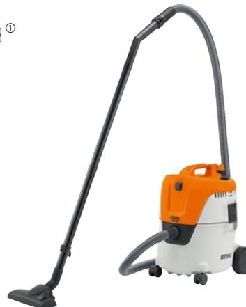
**1,4 kW, 210 mbar, 3.600 l/min.** Zum Entfernen von Staub, Schmutz und Flüssigkeiten – drinnen und draußen. Wahlweise Nass- und Trockensaugen, Blasfunktion durch Umstecken des Saugrohrs auf den Abluftanschluss, Mehrfachfiltersystem, Filterabreinigung, umschaltbare Bodendüse, Universaldüse, Fugendüse.
