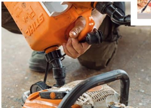
Mit dem Einfüllsystem lässt sich die Motorsäge betanken, ohne Kraftstoff zu verschütten.
