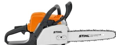
**31,8 cm<sup>3</sup>, 1,4 kW/1,9 PS, 4,1 kg<sup>①</sup>**. Einstiegsmodell zum Brennholzsägen mit mehr Leistung und seitlicher Kettenspannung zum sicheren und einfachen Nachspannen der Kette. 35-cm-Version zum Schneiden von dickeren Ästen, sparsamer 2-MIX-Motor.
