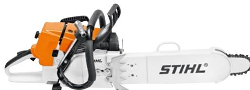
**76,5 cm<sup>3</sup>, 4,4 kW/6,0 PS, 7,2 kg<sup>Ⓛ</sup>.** Für Rettungseinsätze und zur Brandbekämpfung. Zusätzlicher Griff zur schnellen und einfachen Einstellung der Schnitttiefe, großer Anwerfgriff sowie Dekompressionsventil zum einfachen und sicheren Starten der Säge, Spezial-Sägekette mit Aufpanzerung aus schlagzähen Hartmetallplatten.
