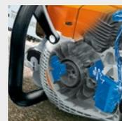
System exakt berechnet und bedarfsgerecht zugeführt. Ansonsten starten Sie wie gewohnt in der Position I. Zudem merkt sich M-Tronic auch die Einstellungen des letzten Einsatzes. So steht bei jedem Neustart unter gleichen äußeren Bedingungen sofort die volle Motorleistung zur Verfügung.
