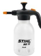
Handspritzgerät mit verstellbarer Düse zur Ausbringung von Reinigungs- und Lösemitteln, z. B. CB 50, Superclean oder Varioclean. 1,5 l Füllvolumen, 3 bar maximaler Druck, EPDM-Dichtungen für Reinigungs- und Lösemittel im pH-Bereich von 7–14. Für eine lange Lebensdauer ist die Pumpe mit einem speziellen Schutzelement versehen.
