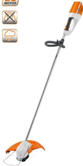
Akku-Motorsense für Mäharbeiten entlang von Hindernissen sowie an Bäumen und Sträuchern. Schneidkreis-Durchmesser 350 mm, stufenlos einstellbarer Bügelgriff, werkzeuglose Griffverstellung, durch Tippen des Mähkopfs auf den Boden stellt sich der Mähfaden automatisch nach, stufenlose Drehzahlregulierung, Abstandsbügel, Gewicht 2,8 kg<sup>Ⓢ</sup>. Mehr zu Ausstattung und technischen Details finden Sie auf Seite 108.
