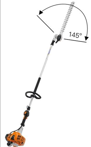
**24,1 cm<sup>3</sup>, 0,9 kW/1,2 PS, 6,1 kg<sup>①</sup>**. Für professionelle Arbeiten an hohen Hecken und den Einsatz in Bodennähe. Gewichtsreduziertes Getriebe, 2-MIX-Motor mit ECOSPEED zur Drehzahlregulierung für lange Arbeitsintervalle in lärmsensiblen Bereichen, STIHL ErgoStart, um 145° schwenkbarer Messerbalken, Gesamtlänge 242 cm.
