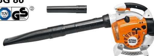
**27,2 cm<sup>3</sup>, 4,4 kg<sup>①</sup>**. Für die Reinigung großer Flächen von Laub und Gras, dank des HD2-Filters auch für die Anwendung in sehr staubiger Umgebung geeignet. Runddüse, Flachdüse, STIHL Antivibrationssystem, STIHL ElastoStart, 2-MIX-Motor, feststellbarer Gashebel mit Stopptaster.
