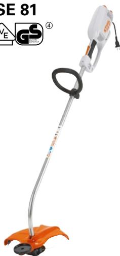
**230 V, 1.000 W, 4,7 kg<sup>Ⓛ</sup>.** Ideal zum Mähen kleinerer Wildwuchsflächen. Softgriff, Bügelgriff, elektronischer Überlastschutz, Tastrad, durch Tippen des Mähkopfs auf den Boden stellt sich der Mähfaden automatisch nach.
