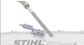
Zum manuellen Bearbeiten des Tiefenbegrenzers aus gehärtetem Stahl mit Spezialbeschichtung. Zwei Einstellungen für Hartholz und Weichholz. Mit dem Haken kann sowohl die Nut als auch die Ölbohrung der Schiene gereinigt werden.
