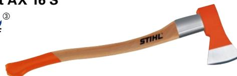
70 cm, 1.550 g<sup>Ⓞ</sup>. Sehr gut geeignet für die Entastung und leichte Axtfällarbeiten, gut geeignet für leichtere Spaltarbeiten. Mit Hickorystiel, Schlagschutzhülse und Sicherungsplatte.
