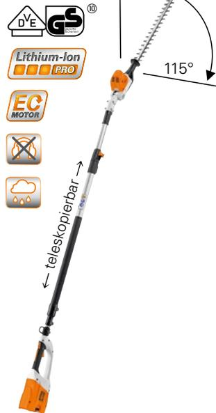
Akku-Heckenschneider für den professionellen Einsatz mit hoher Reichweite durch Teleskopschaft. Stufenlose Drehzahlregulierung, ideal einstellbar für Kopf-, Seiten- und Bodenschnitt, um 115° schwenkbarer Messerbalken, doppelseitig geschliffene Messer. Werkzeuglose Schaftlängeneinstellung durch Schnellspannhebel, Transportlänge 180 cm, Gesamtlänge 260–330 cm, Gewicht 4,4 kg<sup>①</sup>.
