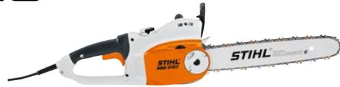
**230 V, 2,1 kW, 4,0 kg<sup>Ⓞ</sup>.** Starke Elektrosäge mit hoher Schnittleistung und sehr guter Ergonomie für kräfteschonendes Arbeiten. Kettenschnellspannung für schnelles und sicheres Nachspannen der Kette ohne Werkzeug, serienmäßig mit Hartmetall-Sägekette <sup>3</sup>/<sub>8</sub>" Picco Duro 3 für Arbeiten im Handwerk.
