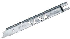
Zur Kontrolle von Brust- und Schärfwinkel, Zahnlänge und Tiefenbegrenzerabstand sowie zum Reinigen von Nut und Ölbohrung der Führungsschiene.
