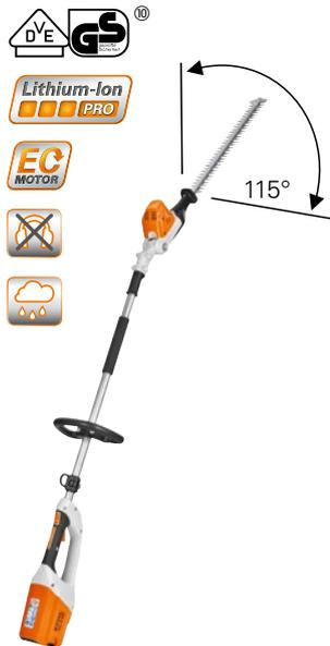
Akku-Heckenschneider für hohe und breite Hecken. Konstanter Messerhub unter Last, zusammenklappbar, ideal einstellbar für Kopf-, Seiten- und Bodenschnitt, um 115° schwenkbarer Messerbalken, lange Reichweite, doppelseitig geschliffene Messer. Transportlänge 125 cm, Gesamtlänge 205 cm, Gewicht 3,5 kg<sup>①</sup>.
